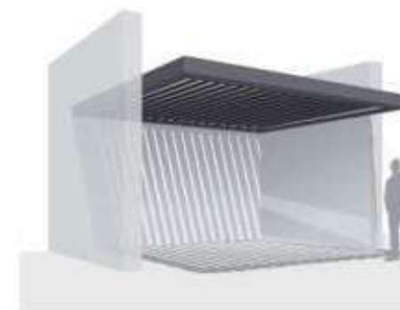
MONTAJE ENTRE MUROS
